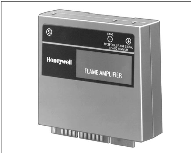
L'amplificateur R7851C est un amplificateur transistorisé enfichable à auto-vérification dynamique destiné à amplifier le signal émis par un détecteur d'ultraviolet de flamme avec contrôle dynamique de l'obturateur type C7961E connecté à un module relais de la série 7800 pour indiquer une présence de flamme.
