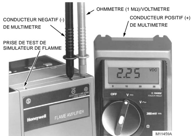
**Fig. 4. Mesure de signal de flamme à l'aide d'un multimètre.**
